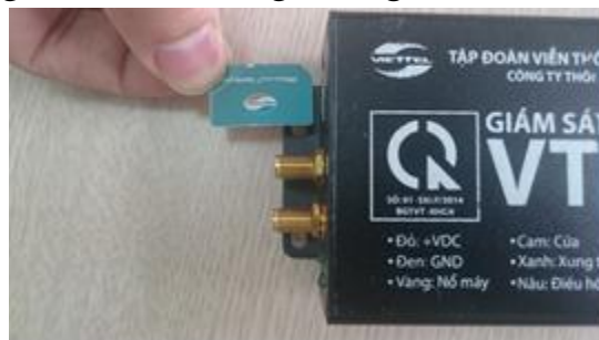
Hình 3.1: Lắp SIM cho thiết bị
