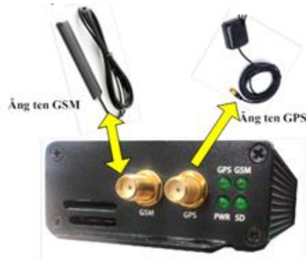
Hình 4.1: Lắp ăng ten cho thiết bị
