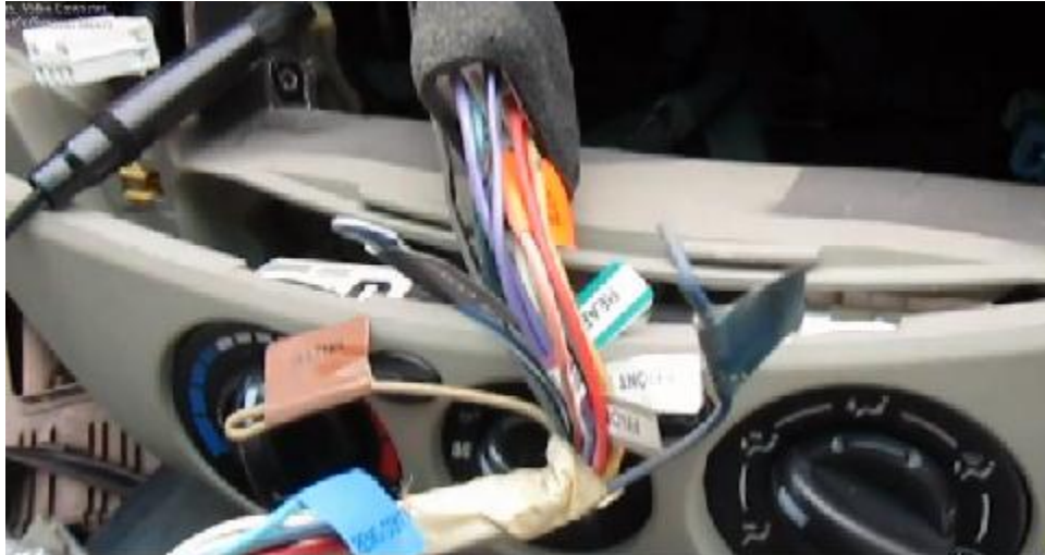
Hình 2.7: Các dây tín hiệu đấu nối với bảng điều khiển điều hòa
