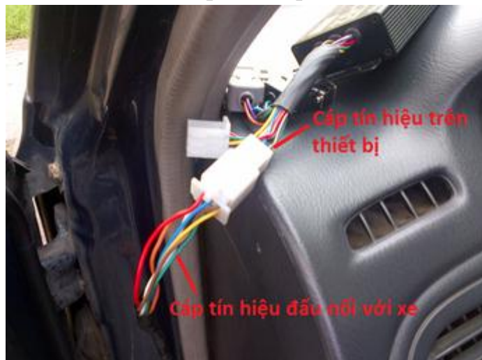
Hình 5.2: Đấu cáp tín hiệu với thiết bị
