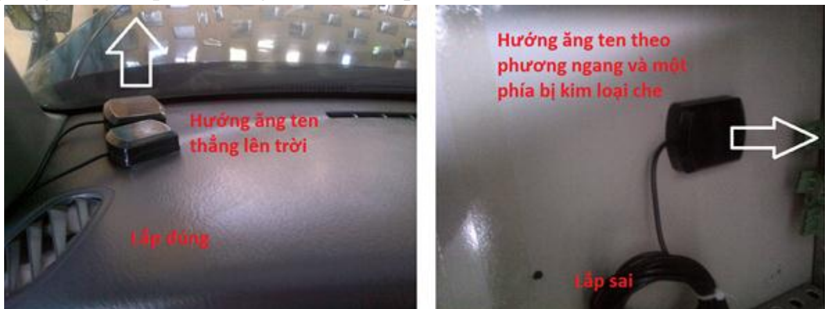
Hình 4.2: Hướng dẫn cố định ăng ten GPS
